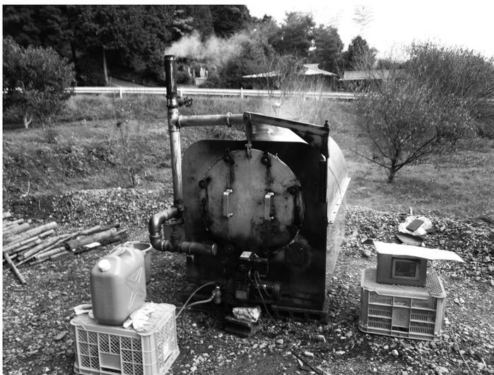
▲高速炭化炉を稼働させている様子
