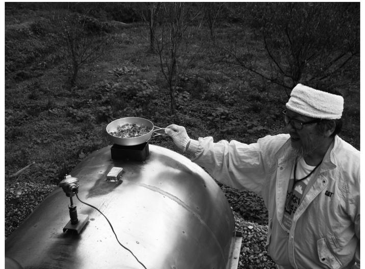
教員の山田先生が開発した「高速炭化炉」なるものをお借りして焼いているが、これは優れもので、なんと約1時間半で炭になる。(ただし取り出すには完全に冷めるまで炉を空けられないが、日帰りができる。)。しかも成功率100%で、竹以外でも何でも炭になる。脱臭・調湿には竹炭が最も効果があることから竹を焼いているが、水害で出た流木もOK!である。この高速炭化炉のもう一つの特徴は、資材のある場所まで炉を運ぶことができるということ。つまり、「移動式高速炭化炉」ということである。是非一度見学に来てください。
